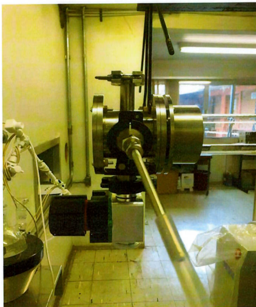
Figura 12 – Entrada do enxofre e dos gases de arraste ( N_2 no caso).
